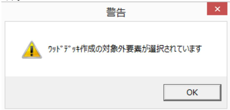
スラブか塗りつぶしツールで作図したものを選択して、ウッドデッキ作成を実行してください。
