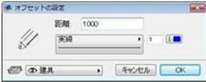
オフセット線の入力を終了するには、[右クリック]-[キャンセル]をクリックします。設定画面が消えて、2Dパレットの表示に戻ります。
