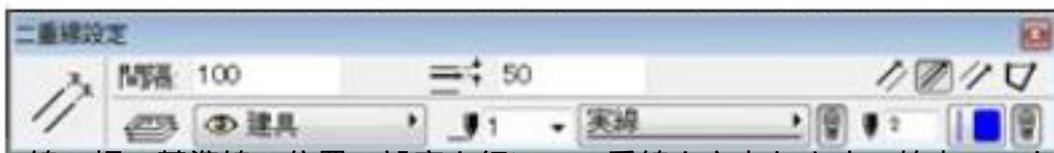
線の幅・基準線の位置の設定を行い、二重線を入力します。始点 でクリックからクリックし、途中でクリックすると、入力方向が変更でき、終点 でダブルクリックすると、二重線が入力されます。
