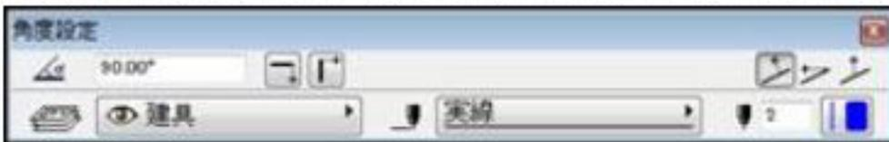
角度固定線の入力を終了するには、[右クリック]-[キャンセル]をクリックします。設定画面が消えて、2Dパレットの表示に戻ります。
