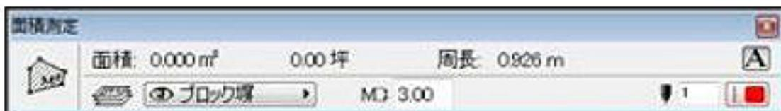
面積を計測するポイントを領域指定していきます。計測途中は面積測定パレットで面積を確認することができます。始点に戻ってくると計測を結果がリセットされます。パレット右上の[A]が有効になっている場合、計測結果を文字ツールの要素として図面上に配置できます。
