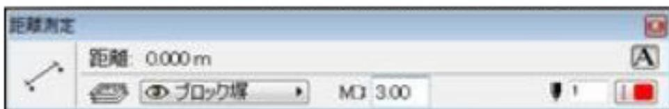
ダブルクリックで計測を終了します。ダイアログ右上の[A]が有効になっている場合、計測結果を文字ツールの要素として図面上に配置できます。
