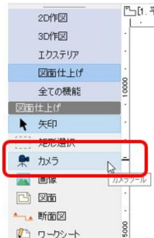
2. 平面図にカメラを配置します。 と の順でクリックします。
