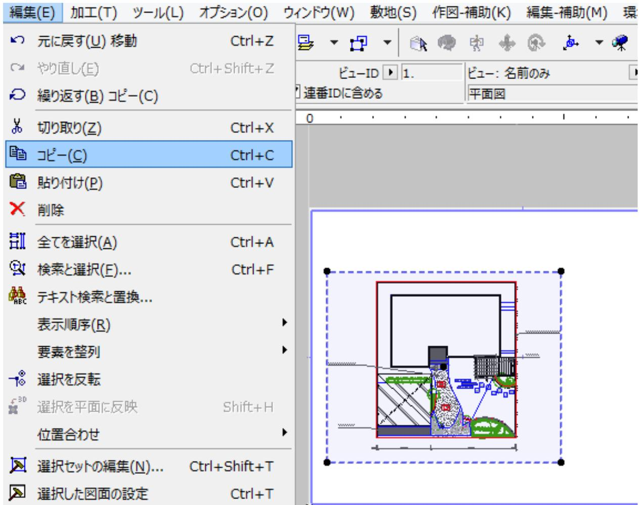
7. 1で開いた元の図面のレイアウトを開き、メニューバー編集 > 貼り付けをクリックします。
