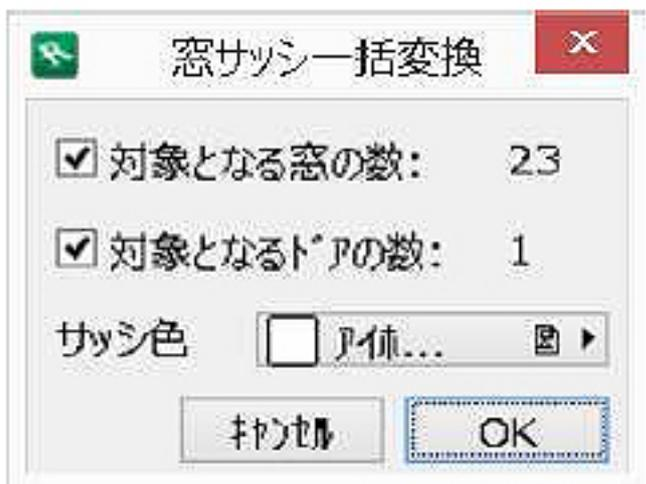
2) 対象となる窓をクリックします。及びドアの数がダイアログに表示されますので変更したいサッシ色のボタンより、材料を選択します。
