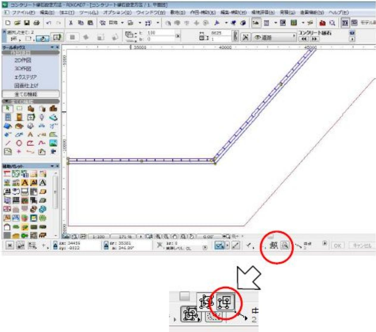
3) 乗り入れ部を作成するコンクリート縁石を矢印ツールで選択します。ここでは以下のような設定で車両の乗り入れ部を作成します。
