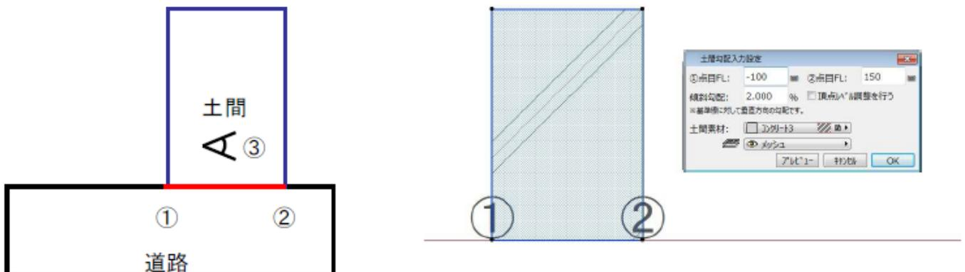
4) 基準線の始点終点の高さ を入力し、傾斜勾配を設定します。[プレビュー]ボタンをクリックすると、各ポイントの高さが表示されます。
