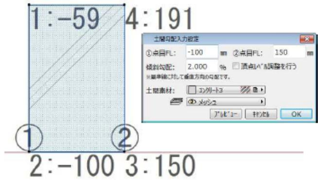
5) 「頂点レベル調整を行う」のチェックを入れておくと、各ポイントの高さを微調整できます。調整後[OK]ボタンをクリックすると、土間の入力が完了します。
