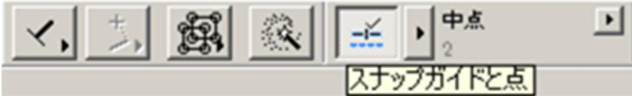
マウスを対象物に合わせて1秒（設定変更可能）待つと参照対象として認識され、「ESCキー」で解除するまでマウス追従します。
