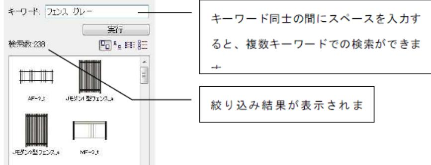
4 ) 商品検索で表示されたデータを配置するには、使用する商品を選択して画面右側の[パラメータ]等で設定を行ったうえ、[OK]ボタンをクリックし図面上に配置します。
