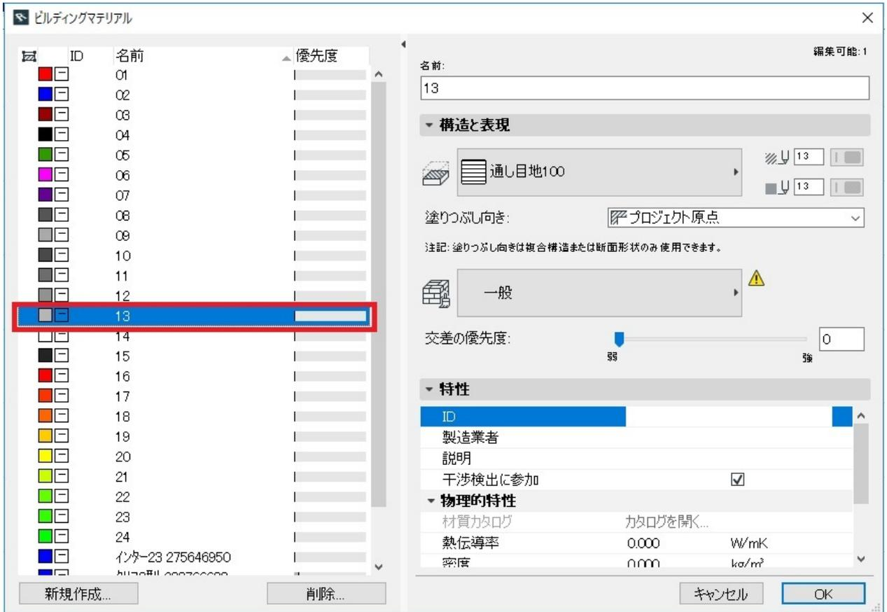
3. 右の構造と表現よりハッチングを空の塗りつぶしに変更します。
