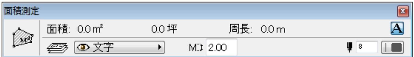
2) 面積を計測するポイントを領域指定していきます。計測途中は面積測定パレットで面積を確認することができます。始点に戻ってくると計測の結果がリセットされます。パレット右上の[A]が有効になっている場合、計測結果を文字ツールの要素として図面上に配置できます。
