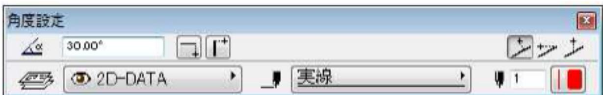
4) 角度固定線の入力を終了するには、[右クリック]-[キャンセル]をクリックします。設定画面が消えて、2Dパレットの表示に戻ります。
