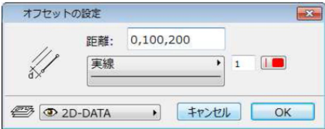
2) オフセット線の入力を終了するには、[右クリック]-[キャンセル]をクリックします。設定画面が消えて、2Dパレットの表示に戻ります。
